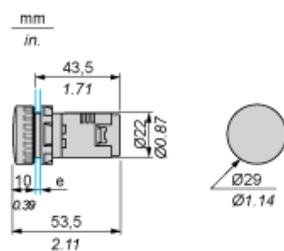
e Grosor del panel de soporte: de 1 a 6 mm (de 0,4 a 0,24 in) (metal), de 2 a 6 mm (de 0,8 a 0,24 in) (plástico).
