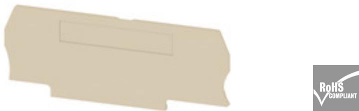
Abschlussplatten werden an der offenen Seite der letzten Reihenklemme vor dem Endwinkel befestigt. Mit dem Einsatz der Abschlussplatte wird die Funktion der Reihenklemme sowie die angegebenen Bemessungsspannung aufrechterhalten. Ein Berührungsschutz von Spannungsführenden Teilen wird gewährleistet, und die Abschlussklemme ist fingersicher.
