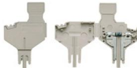
Der Bauelementstecker dient dem integrieren einer elektrischen Komponente in einer Trennreihenklemme. Nach dem Einlöten der jeweiligen Komponente lässt sich der Stecker in den Trennbereich unserer Reihenklammen integrieren und ändert dadurch die Trennklemme zu einer Reihenklemme mit integrierter elektronischen Komponente.
