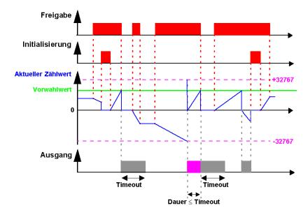
Der Ausgang wechselt in den Zustand **Inaktiv**, wenn die im Parameter "Impulsdauer" festgelegte Zeit abgelaufen ist. Wenn die Übergangsbedingung vor dem Übergang in den Status "Inaktiv" erfüllt ist, wird der Ausgangsimpuls um die **Impulsdauer** verlängert (Timeout).
