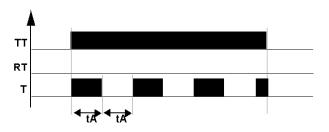
Typ PD: **Blinklicht**; **Ein-/Ausschalten durch Impuls** Die folgende Abbildung zeigt die Funktionsweise des Timer-Typs PD:
