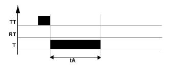
Typ D: **Symmetrisches Blinken** für aufrechterhaltenen synchronen Befehl. Die folgende Abbildung zeigt die Funktionsweise des Timer-Typs D:
