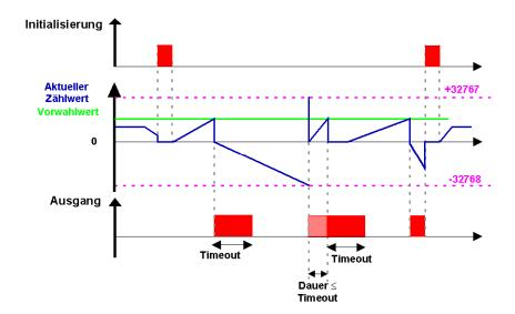
Der Ausgang wechselt in den Zustand "Inaktiv", wenn die im Parameter "Impulsdauer" festgelegte Zeit abgelaufen ist. Wenn die Übergangsbedingung vor dem Wechsel in den Zustand "Inaktiv" erfüllt ist, wird der Ausgangsimpuls um die **Impulsdauer** verlängert (Übergang).
