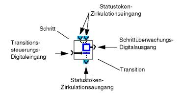
Dem Ausschalten einer Funktionsphase (B01) folgt unmittelbar der Start der folgenden Funktionsphase (B02). Die folgende Funktionsphase wird ebenfalls durch einen neuen Schritt symbolisiert. Ihr Ende wird auch von einer Transition kontrolliert.
