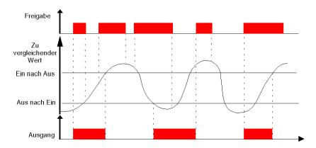
Die folgende Abbildung zeigt die verschiedenen Zustände, die der Ausgang in dem Fall annehmen kann, in dem der **Sollwert von Aus nach Ein** größer als der **Sollwert von Ein nach Aus** ist:
