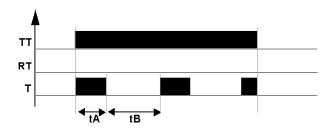
Typ I: **Blinklicht; zum Starten/Stoppen drücken**. Das folgende Diagramm zeigt die Funktionsweise des Timer-Typs I:
