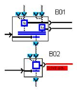
Wenn ein einziger Token in einer der vorgeschalteten Schritte vorhanden und der andere Schritt leer ist (inaktiv), so passiert – selbst wenn sich die Transition im Status ON befindet – nichts. Der Schritt, der den Token enthielt, bleibt aktiv (Schrittüberwachungs-Digitalausgang im Status ON), und der nachgeschaltete Schritt (B03) bleibt inaktiv.
