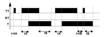
Typ L: **Blinklicht**; **aufrecht erhaltener asynchroner Befehl** Das folgende Diagramm zeigt die Funktionsweise des Timer-Typs L:
