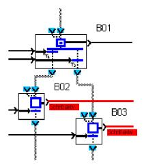
**HINWEIS:** Wenn die Wahl zwischen den beiden folgenden Funktionsphasen exklusiv sein soll, muss eine der beiden Transitionen durch ein **AND** gesteuert werden, wobei der Befehl der ersten Transition mit der Umkehrung des Befehls der zweiten Transition kombiniert wird.
