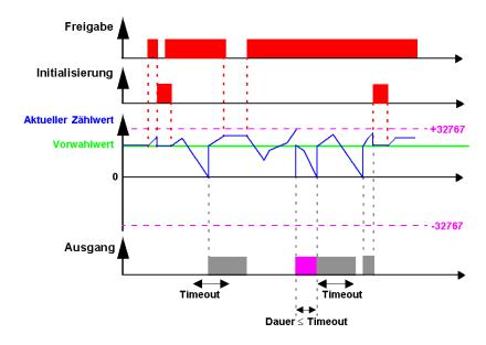
Der Ausgang wechselt in den Zustand **Inaktiv**, wenn die im Parameter "Impulsdauer" festgelegte Zeit verstrichen ist. Wenn die Übergangsbedingung vor dem Übergang in den Status "Inaktiv" erfüllt ist, wird der Ausgangsimpuls um die **Impulsdauer** verlängert (Timeout).
