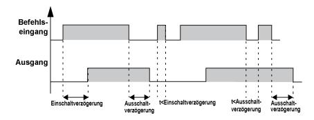
Das folgende Diagramm veranschaulicht die Funktionsweise des Timers, wenn der **Initialisierungseingang** aktiviert wird, mit dem Timer in Funktion A/C:
