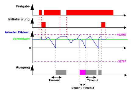
Der Ausgang wechselt in den Zustand **Inaktiv**, wenn die im Parameter "Impulsdauer" festgelegte Zeit abgelaufen ist. Wenn die Übergangsbedingung vor dem Übergang in den Zustand "Inaktiv" erfüllt ist, wird der Ausgangsimpuls um die **Impulsdauer** verlängert (Timeout).
