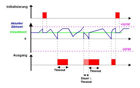
Der Ausgang wechselt in den Zustand "Inaktiv", wenn die im Parameter "Impulsdauer" festgelegte Zeit abgelaufen ist. Wenn die Übergangsbedingung vor dem Übergang in den Zustand "Inaktiv" erfüllt ist, wird der Ausgangsimpuls um die **Impulsdauer** verlängert (Timeout).
