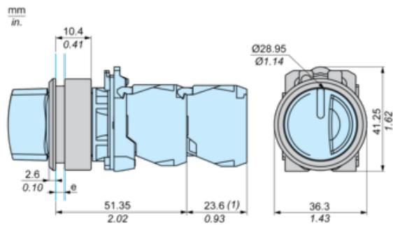
e: Spessore fissaggio: da 1 a 3,5 mm / da 0,04 a 0,14 in.
