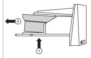
4 Legen Sie die neue Batterie in die Batteriehalterung ein. Achten Sie dabei auf die Polaritätsmarkierungen auf der Batterie:
