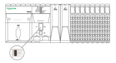
**HINWEIS:** Der USB-Typ-A-Hostport bietet 500 mA Dauerstrom (USB-Standard) sowie 700 mA für kurze Stromspitzen.
