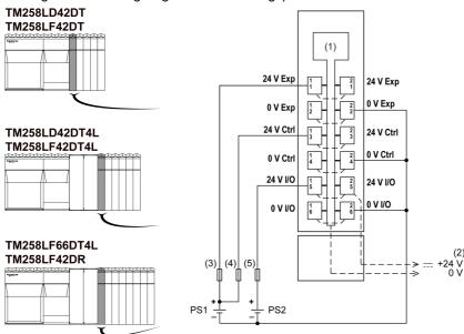
Die folgende Abbildung zeigt den Verdrahtungsplan für das SPS-Stromverteilermodul (CPDM):
