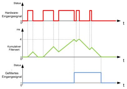
**HINWEIS:** Der für den Zeitparameter des Filters ausgewählte Wert definiert die Gesamtzeit in ms, die verstreichen muss, bevor der Eingang als logisch 1 interpretiert wird, sowie die Zeit, die das gefilterte Eingangssignal auf logisch 1 verbleibt.
