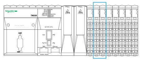
Die Steuerung weist 2 Module mit integrierten Experten-E/A auf. Jedes Modul besteht aus:
