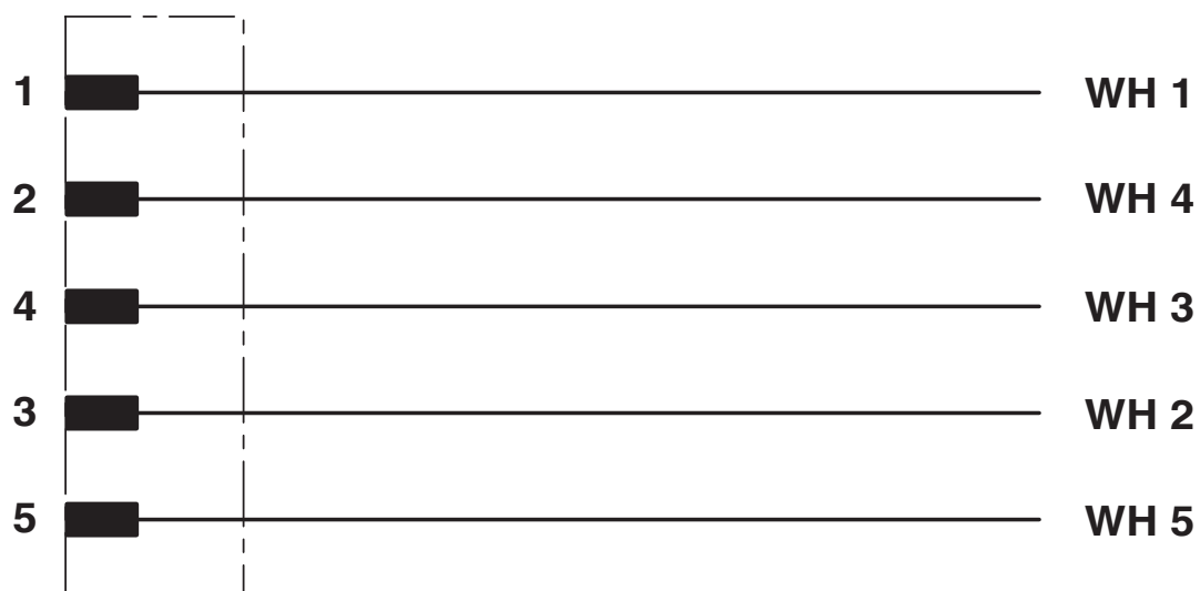
Schéma de connexion
