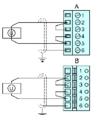
thermocouple à 2 fils et capteur de tension (mV)
